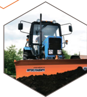
Конструкция позволяет работать с грунтом 1-ой категории
