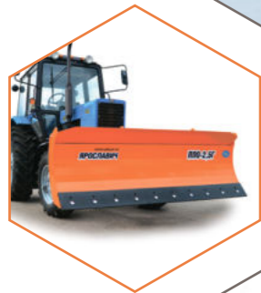
Отвал может эксплуатироваться с дополнительными боковыми уширителями и без них
