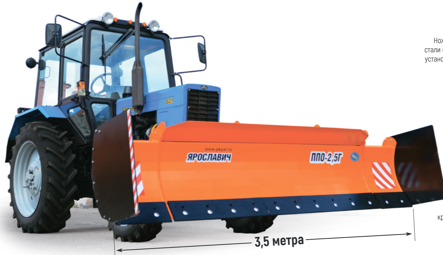
Конструкция позволяет работать с грунтом 1-ой категории
