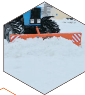
Отвал может эксплуатироваться с дополнительными боковыми уширителями и без них
