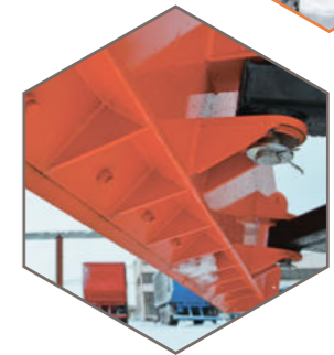
Усиление нижней кромки крыла за счет ребер жесткости
