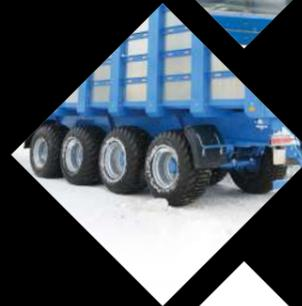
**Надежная рессорная тележка** с подруливающими осями в базовой комплектации. Имеет колеса большого диаметра и ширины, которые обеспечивают высокую проходимость и снижают давление на грунт.
