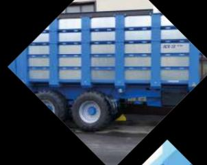
**Принципиально новая разборная конструкция кузова** имеет самые высокие пределы жесткости и полностью исключает распирающие бортов без использования дополнительных стяжек.
