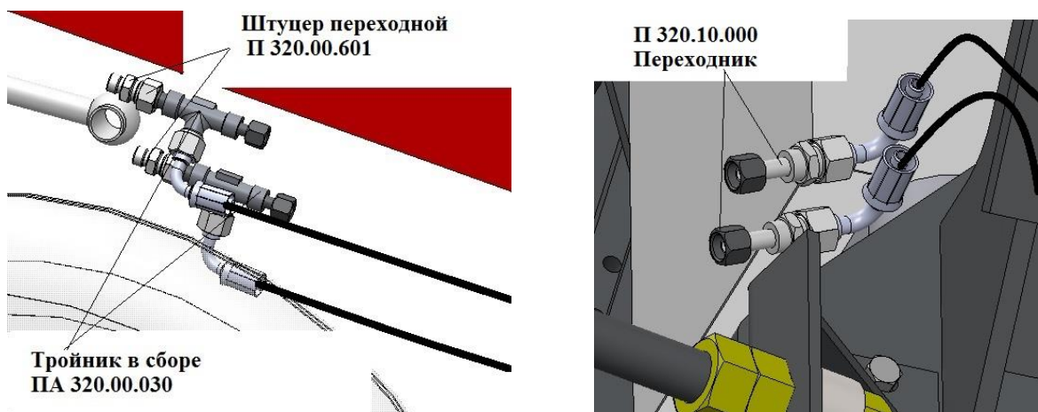
Рисунок 17 – Подсоединение гидросистемы погрузчика к гидросистеме трактора
