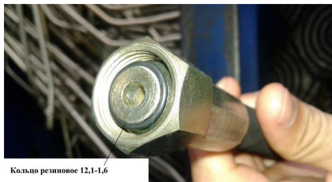
Рисунок 16 – Установка резинового кольца КУН 2000.00.005
